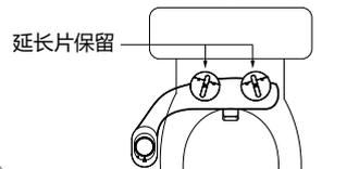
2. 水箱与马桶盖较近时，可拆卸延长片
