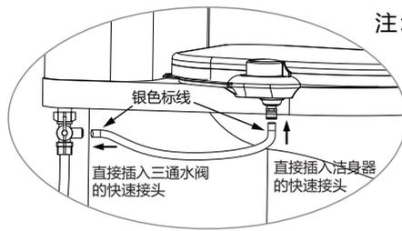
注：水管两端插入快速接头时务必用力插到“银色标线”处，否则容易造成接合处漏水。
